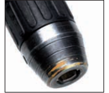
Matkabın, mandren duvar veya diğer sert yüzeylere karşı çalışacak şekilde kullanılmasından kaynaklanan aşınma
