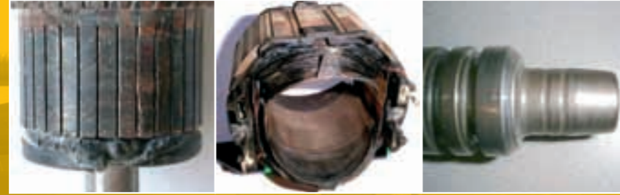
Erimiş uç parça - aşırı yüklenmeden kaynaklı
