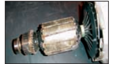
Armatürün yanması (aşırı yüklenmeden kaynaklı)
