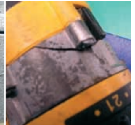
Düşürülen ünitedeki çatlaklar
